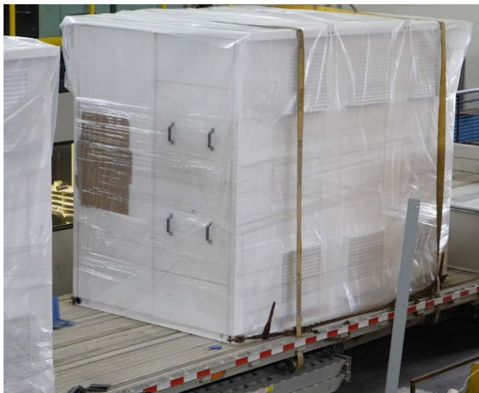
Figure 1: Emballage d'expédition de transformateur fermé (illustré avec bâche enlevée)
