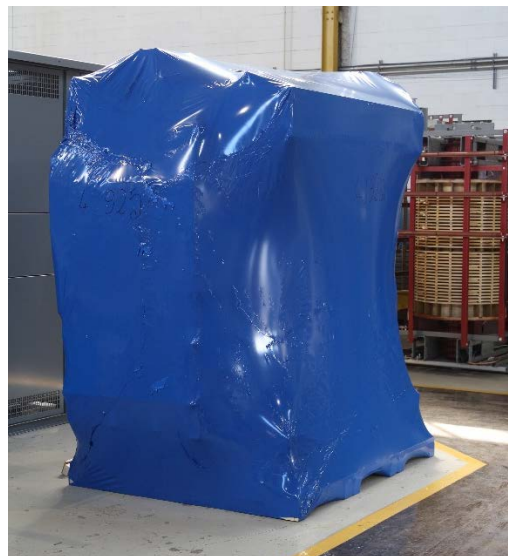
Figure 2: Transformateur noyau-bobines avec emballage thermo rétractable
